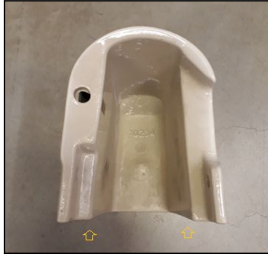
Şekil 1.Sürtünme yüzeyi iç kısmı kavislendirilmiş vitrifiye seramik
