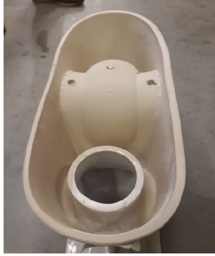
Şekil 6. Taşlama işlemi yapılarak düzeltilmiş klozet
