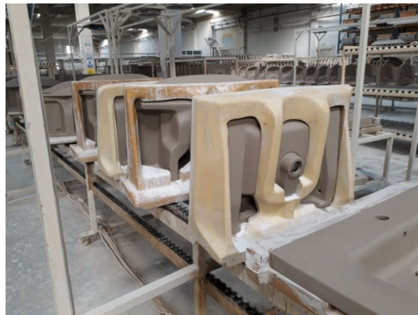
Şekil 5. Kurutulmak için mal alma ceketı içerisine konulmuş lavabo
